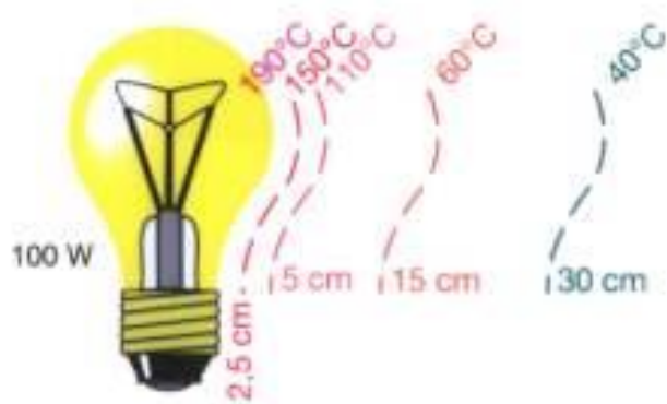
Zmiany temperatury otoczenia na przykładzie żarówki 100W
