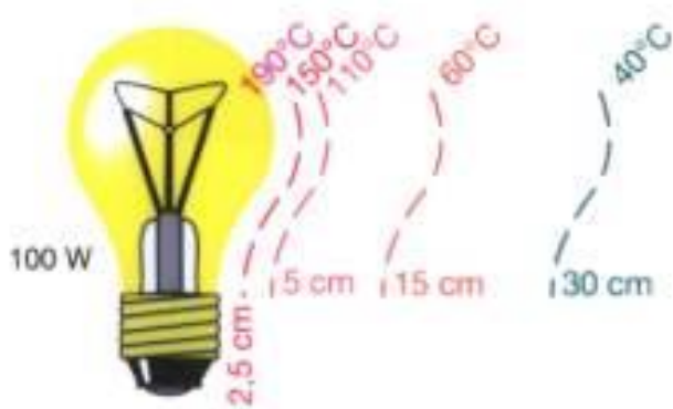
Zmiany temperatury otoczenia na przykładzie żarówki 100W
